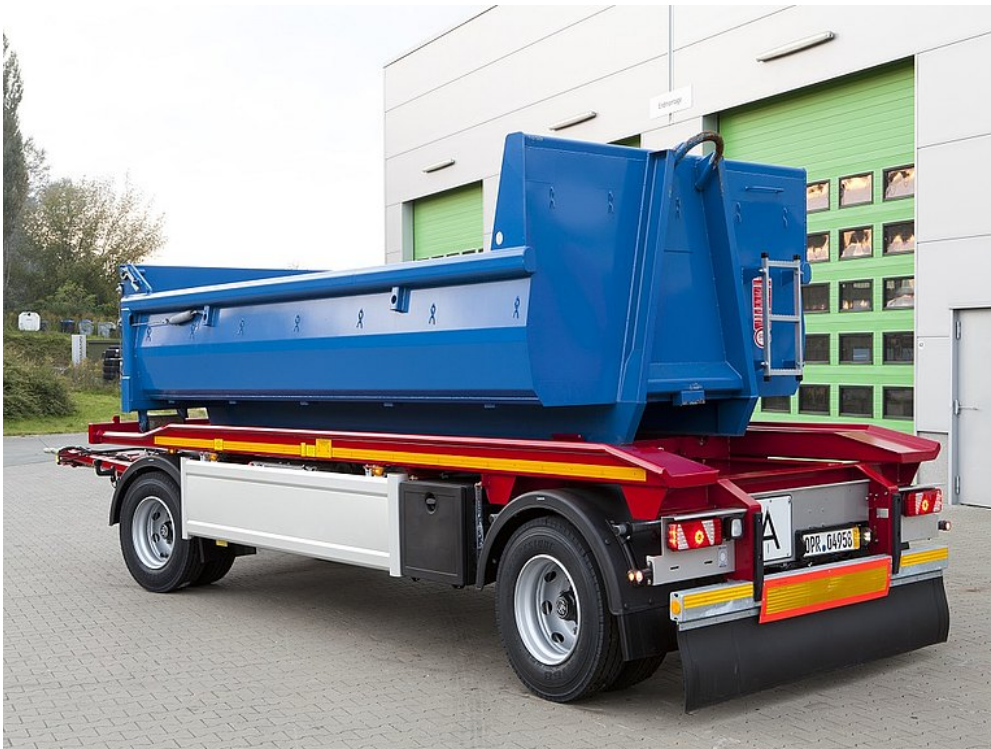
Wszechstronna naczepa do przewozu krótkich kontenerów rolkowych
