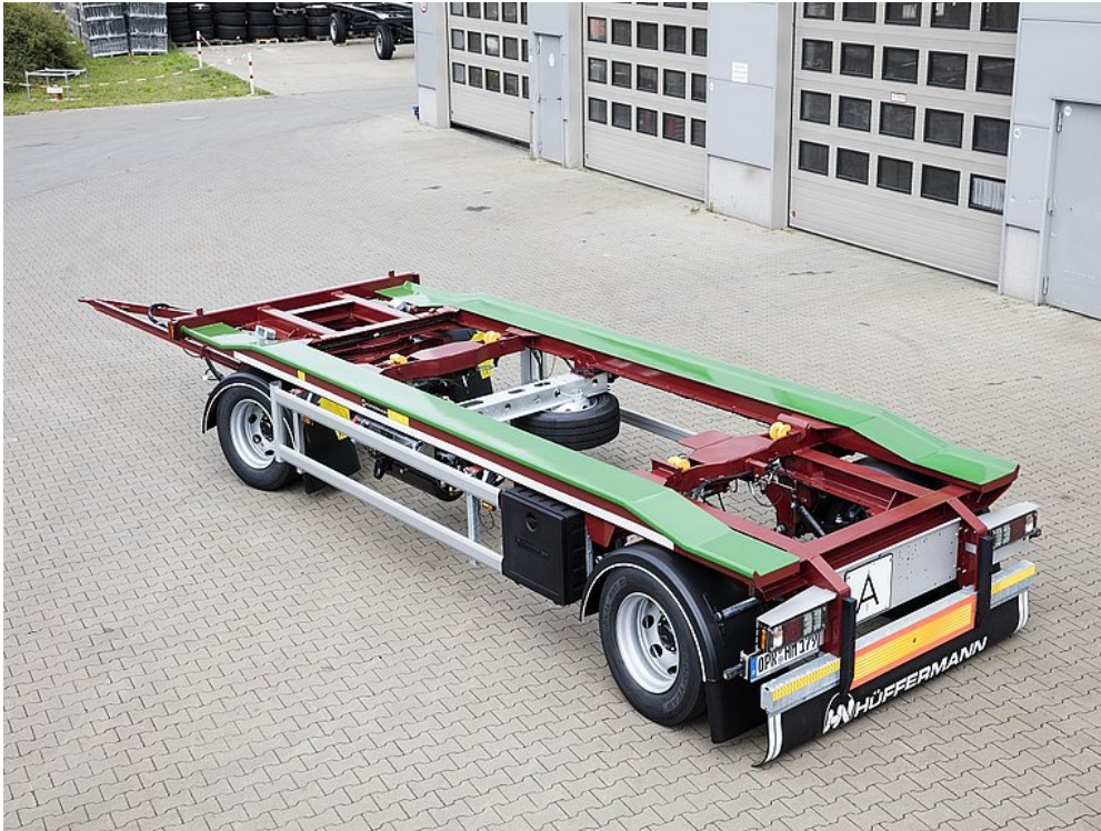
OPCJA WYPOSAŻENIA: Możliwość załadunku z boku
