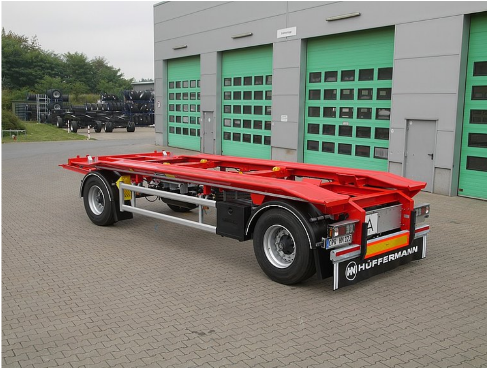
Wykonanie specjalne z poszerzoną bieżnią do centrowania wewnętrznego i zewnętrznego
